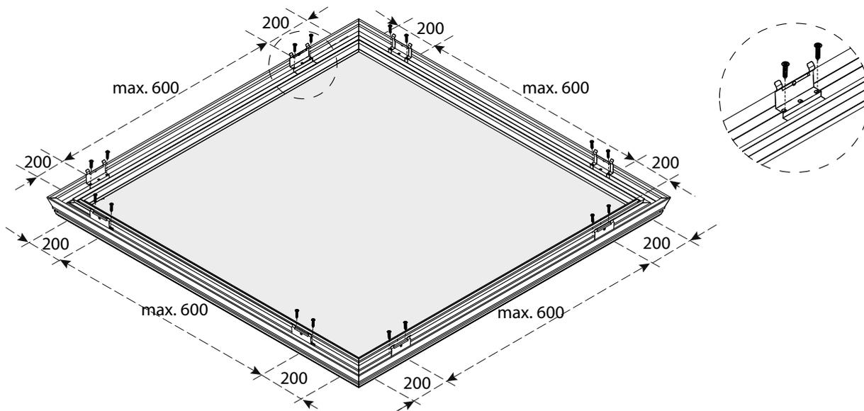
Retourner et positionner l'ensemble au-dessus de la costière! Veillez à ce que les clips et l'ensemble du châssis et du vitrage, ne soient pas posés directement sur le revêtement de toiture ou sur le sous-sol (pour éviter un endommagement éventuel au revêtement de toiture ou aux clips). Présentez le châssis sur la costière et répartissez le jeu de manière égale sur les 4 faces de la costière. Appuyez simplement sur le châssis pour que celui-ci clipse à la costière.
