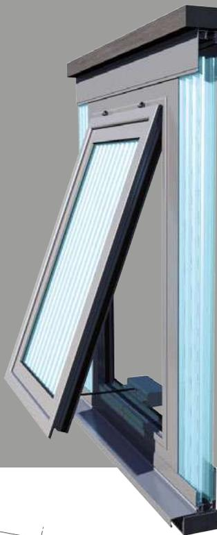
Tous les systèmes **Modulit®** peuvent être dotés d'ouverture en saillie pour consentir l'aération parfaite du bâtiment. Le système d'ouverture est composé de profils inférieurs et supérieurs en aluminium, dotés de joints en caoutchouc EPDM pour la fermeture complète et de charnière supérieures en aluminium anodisé. L'ouverture peut être à commande électrique au moyen d'un actionneur placé dans le système.
